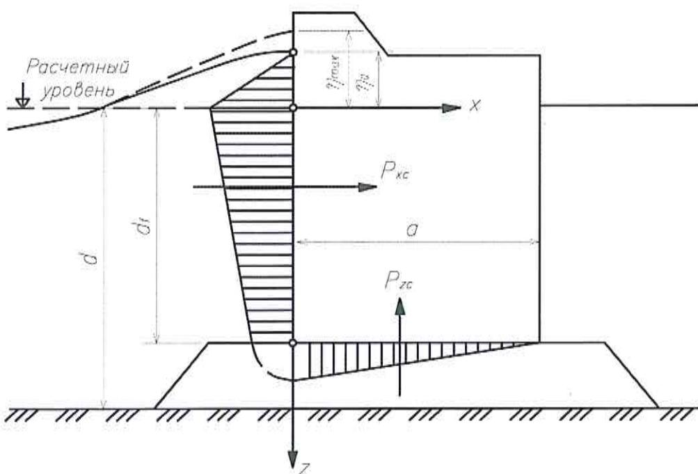
Рисунок 7.2 – Эпюра давления гравитационной волны на вертикальную стенку
