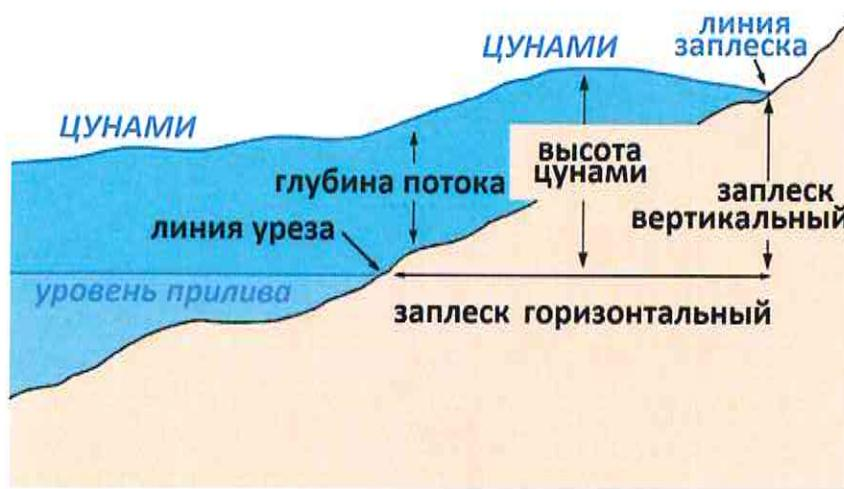
**Рисунок А.10 – Схема стандартного цunamiопасного побережья с характеристиками наката цунами**
