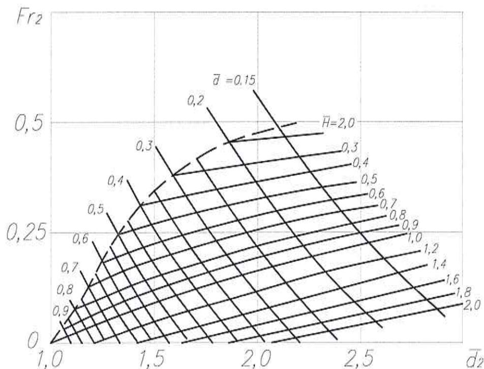
**Рисунок 8.10 – Графики для определения значений  $Fr_2$  и  $\bar{d}_2$  в случае  $b > 2(d_2 - H)$**
