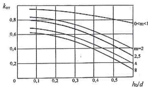
**Рисунок Д.1 – График для определения коэффициента отражения  $k_{\text{от}}$  в зависимости от относительной высоты волны  $h_0/d$  и заложения откоса  $m = \operatorname{ctg}\varphi$**
