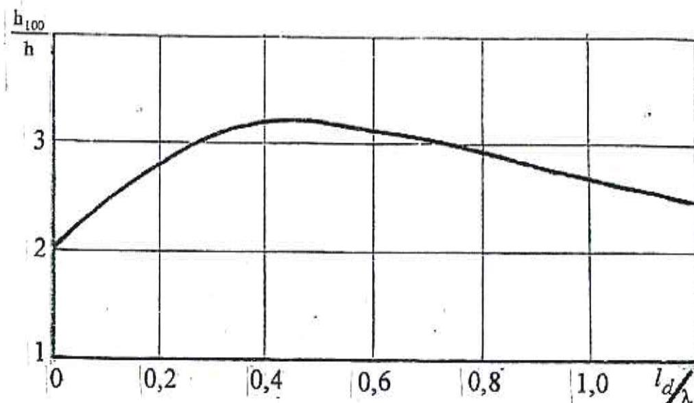
**Рисунок Г.1 – График для определения вертикального заплеска**
