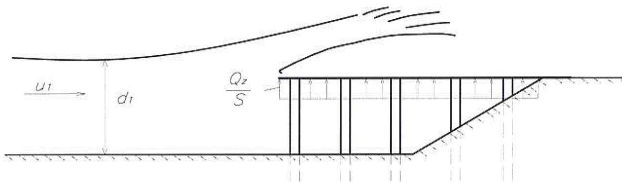
**Рисунок 8.12 – Схема взаимодействия бора со сквозным сооружением**
