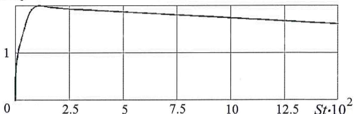
**Рисунок 6.5 – График для определения максимальной скорости на урезе при откате волны**
