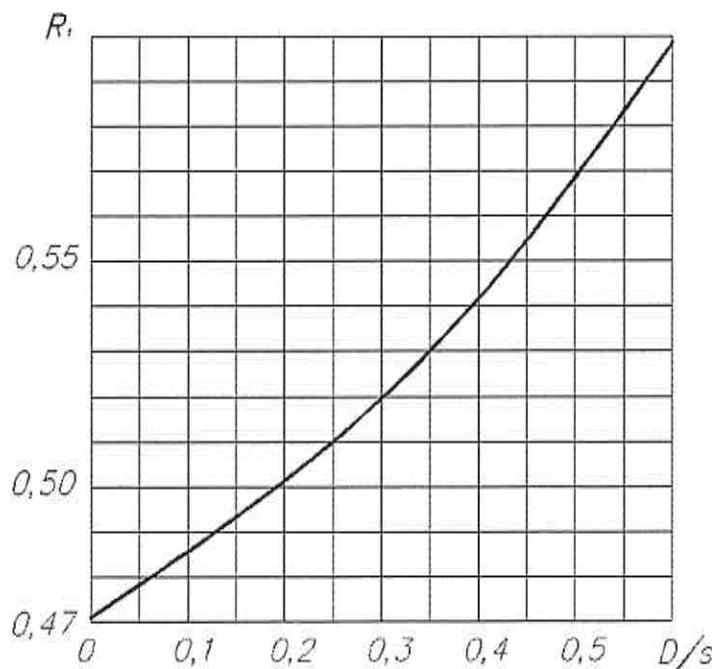
**Рисунок 7.6 – График для определения коэффициента  $R_1$**
