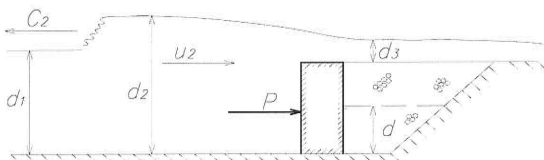
Рисунок 8.8 – Схема взаимодействия бора в фазе отражения с причальным сооружением,  $d_2 > H$
