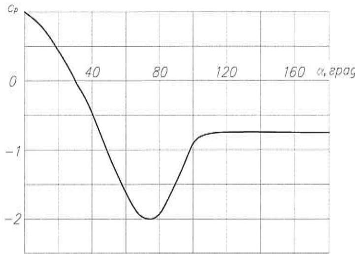
**Рисунок 9.9 – Распределение значений  $c_p$  по контуру окружности**
