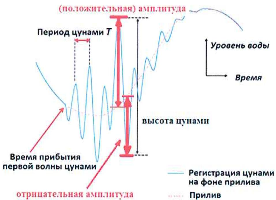
**Рисунок 4.1 – Пример регистрации параметров цунами при подходе волны к берегу**
