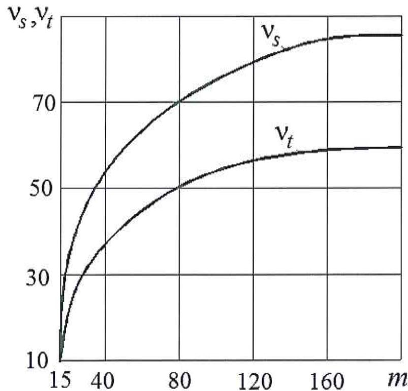
Рисунок 6.8 – Зависимость отношения  $v_s, v_t$  от уклона берега
