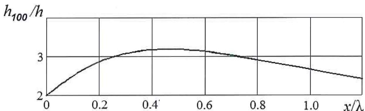
Рисунок 6.3 – График для определения вертикального заплеска
