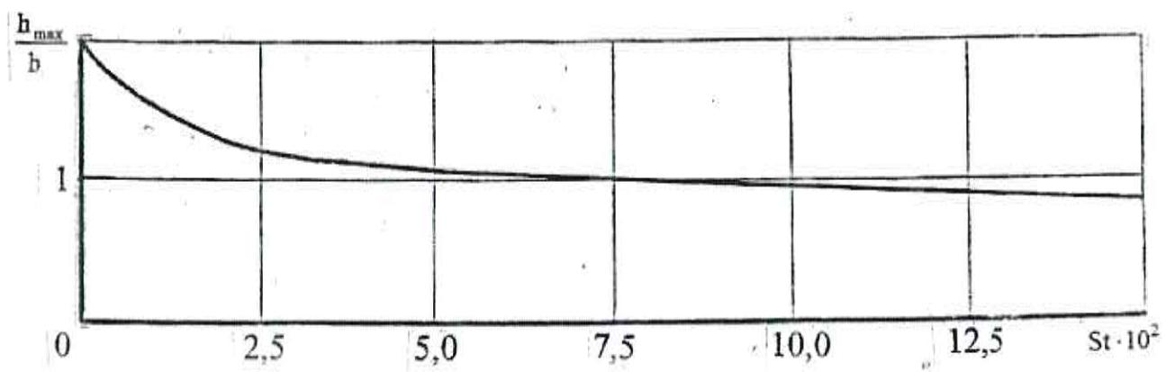
**Рисунок Г.3 – График для определения высоты волны на урезе**
