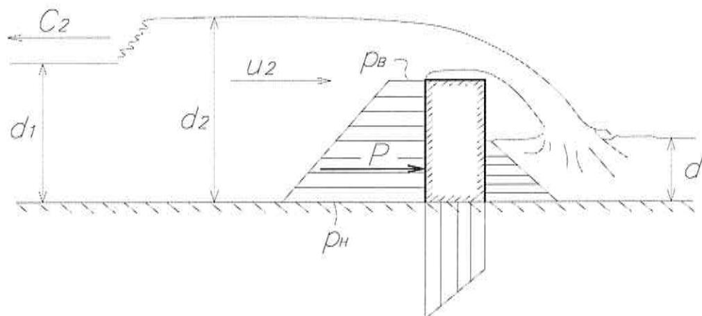
Рисунок 8.7 – Схема взаимодействия бора в фазе отражения с ограждительным сооружением,  $d_2 > H$
