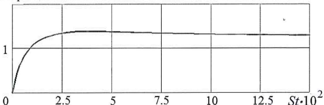
**Рисунок 6.4 – График для определения максимальной скорости на урезе при накате волны**
