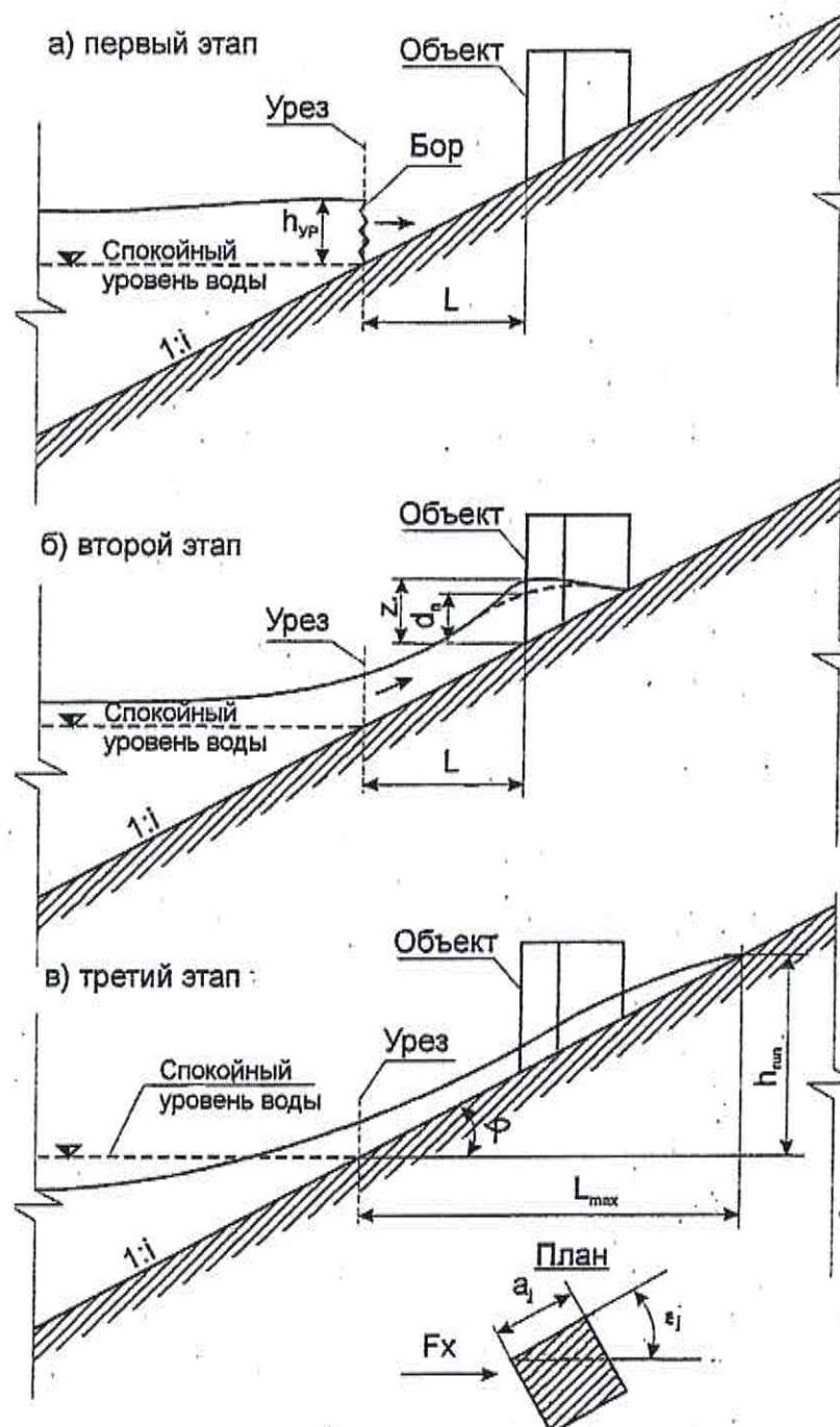
Рисунок 9.1 – Схема воздействия бора на береговой объект
