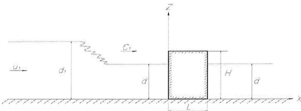
$u_1$  – скорость набегающего потока;  $d_1$  – глубина воды перед фронтом бора;  $d$  – глубина у сооружения;  $H$  – высота сооружения;  $L$  – ширина сооружения по лучу волны
