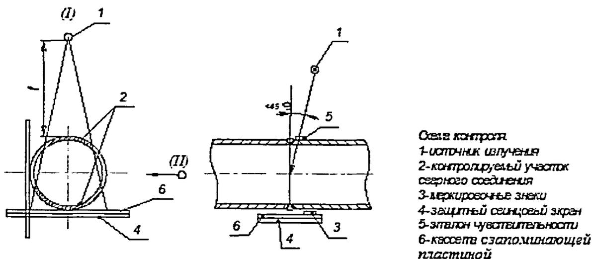
Рисунок - Схема просвечивания (СДОС-01-2008. рисунок 2в)
