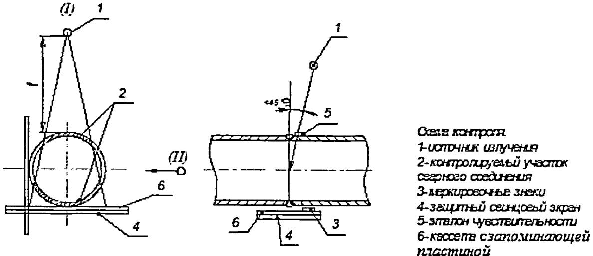
Рисунок - Схема просвечивания (СДОС-01-2008. рисунок 2в)
